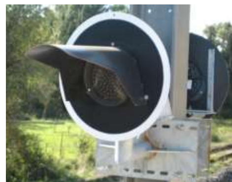
Illustration 20. Exemple de sirènes et lampes flash équipant la section en voie unique du tramway de Montpellier
